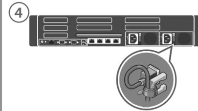
4 Recoja y asegure el cable de alimentación utilizando el clip de retención.
