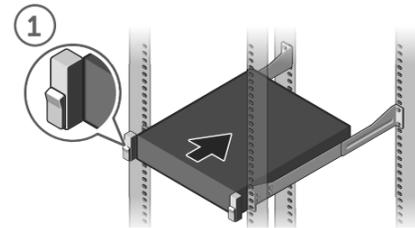
1 Instale el sistema en un bastidor.
